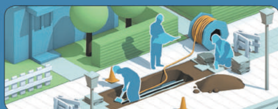
Stap 1 Aanleg van glasvezel in de straat.
