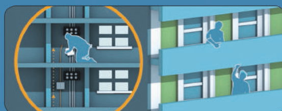
Stap 3b Glasvezelaansluiting bij hoogbouw, appartementen en flats.
